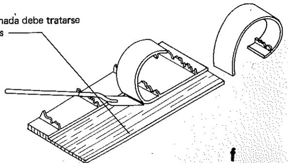
El bambú tiene la particularidad de poderse rajar muy fácilmente en sentido longitudinal, lo cual permite transformarlo respectivamente en canales, latas y cintas que tienen una gran diversidad de aplicaciones en la construcción de vivienda y en artesanías.
