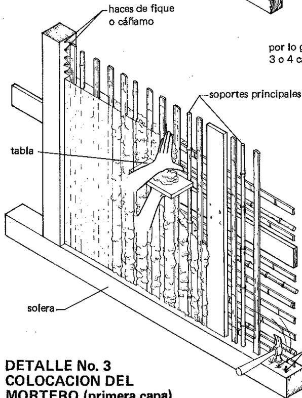
**DETALLE No. 3 COLOCACION DEL MORTERO (primera capa)**
