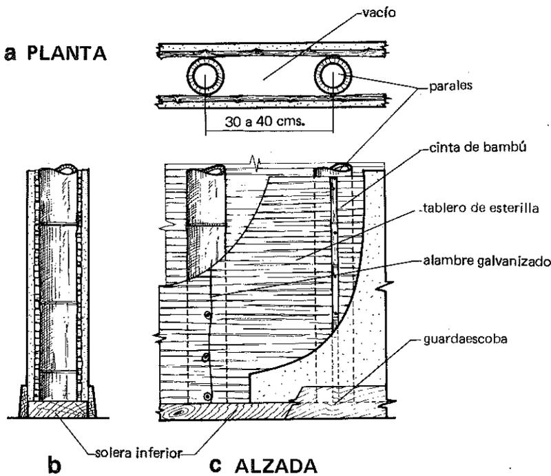
El entramado o estructura de la pared de bahareque está formado por parales de bambú de 10 centímetros de diámetro promedio, colocados a distancias iguales que pueden variar entre 30 y un máximo de 40 centímetros, los cuales una vez plomados se clavan a las soleras de madera o bambú, inferior y superior.
