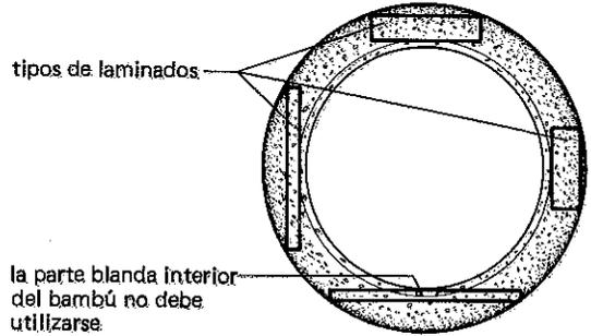
SECCION TRANSVERSAL DEL BAMBU
