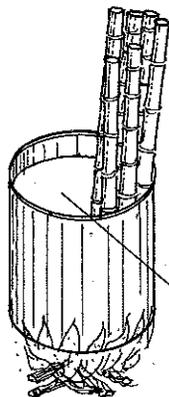
cuando se empleen columnas o soportes enterrados parcialmente, estos deben impregnarse previamente con asfalto caliente hasta 30 cms. por encima del nivel del suelo
