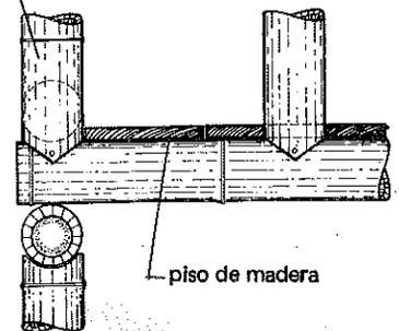
**Construcción del piso y del entramado de la pared
