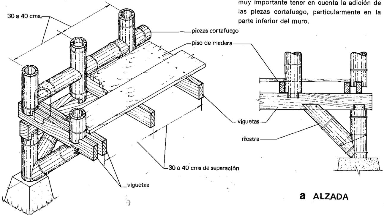
De acuerdo a la forma de unión del entramado y las viguetas del suelo (ver detalle) es muy importante tener en cuenta la adición de las piezas cortafuego, particularmente en la parte inferior del muro.
