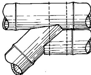
**4** Unión del diagonal con la parte inferior del tirante o de una viga.
