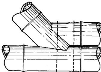
**3** Unión del diagonal con la parte superior del tirante.
