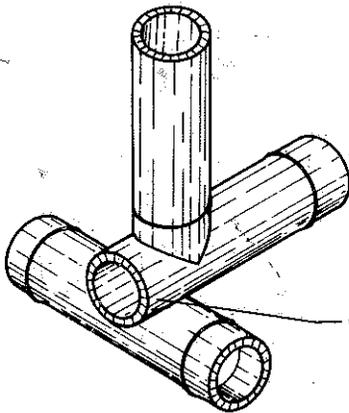
de no existir el nudo se produce el aplastamiento
