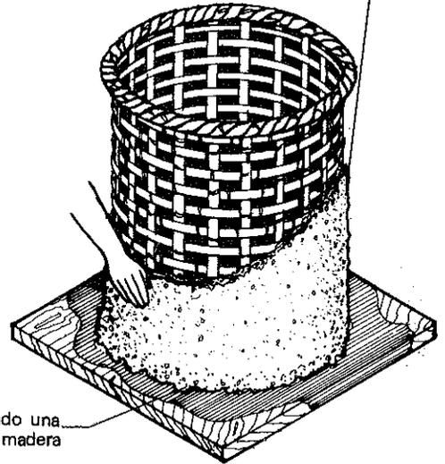
el espesor total de la pared del tanque debe tener por lo menos 3 cms.
