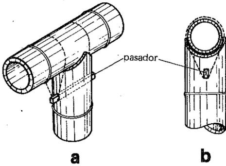
**1** Unión de piezas con amarre y clavija. La clavija puede colocarse en la columna ya sea paralela o perpendicular a la viga.
