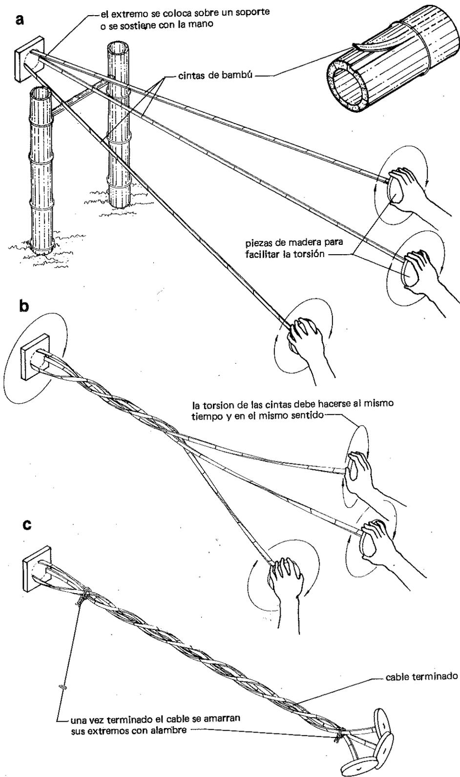
Los cables de bambú se hacen con 3 ó más cintas obtenidas solo de la parte externa o más compacta de la pared de bambúes de 2 años de edad, sus dimensiones pueden variar entre uno y 3 milímetros de espesor y hasta 10 milímetros de ancho.
