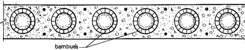
SECCION TRANSVERSAL DE LA LOSA DE CONCRETO
